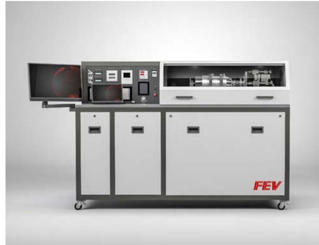
Turbolader Reibleistungsprüfstand Zur Vermessung der mechanischen Verluste in der Turbolader-Lagerung
