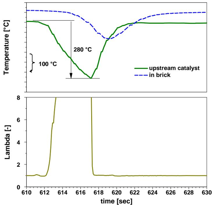
Fig. 8: ZDAKW cycle on hot gas test bench
