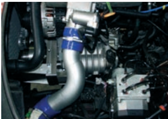
Abb. 4: Kombinierte Aufladung Roots + Turbo im Fahrzeug
