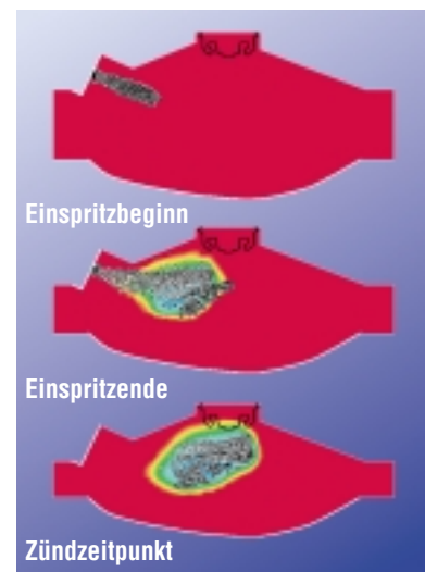
Abb. 2: DISI Strahlausbreitung und Gemischbildung bei Teillastbetrieb (2000 1/min, pme = 2 bar)
