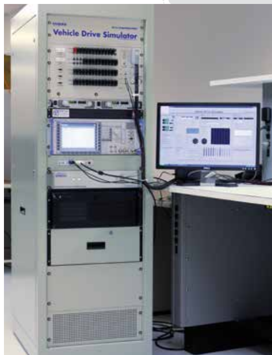
Abb. 16: FEV Telematics System Tester (TST) zur Simulation vernetzter Fahrzeuganwendungen im Testlabor
