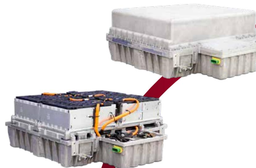
4. Von FEV entwickeltes Batteriepack für den frühen Feldtest des New Daily Electric.
