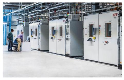
In der neuen Testeinrichtung von FEV France können bis zu zwei Batteriepacks gleichzeitig unter extremen Umweltbedingungen von -40 bis 70 °C getestet werden.
