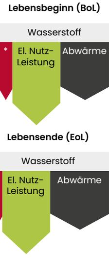
3. Verallgemeinerter Zusammenhang zwischen Brennstoffzellen-Nettoleistung und Abwärme sowie parasitären Verlusten der Nebenaggregate (Balance-of-Plant(-BoP)-Komponenten).
