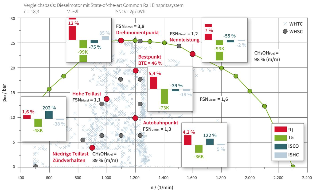
Im Bestpunkt bei 1.200 1/min und BMEP ~20 bar, der auch in Abbildung 1 dargestellt ist, kann der Wirkungsgrad um ~5 Prozent gesteigert werden, während die Abgastemperatur um ~73 Kelvin reduziert wird. Die CO-Emissionen sind in beiden Fällen auf geringem Niveau. Der Dieselmotor muss zur Erreichung des ISNO<sub>x</sub>-Niveaus allerdings nahe der Rußgrenze betrieben werden (FSN = 1,6).
